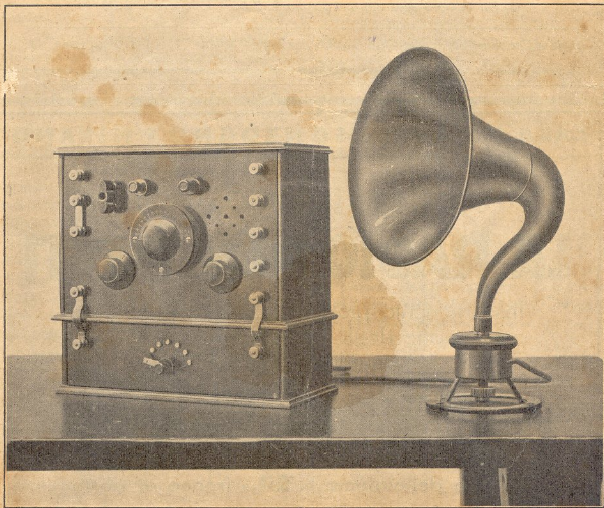
APPARECCHIO SUPERRIGENERATIVO AD UNA VALVOLA
